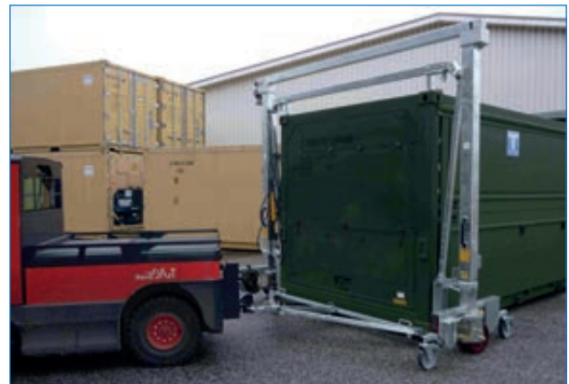
Hebesystem Typ 260 mit automatischer Lageregelung.
