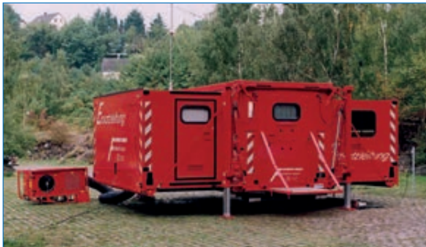
Hebesystem Typ 260 mit Schubausleger für Feuerwehreinsatz- leitung.
