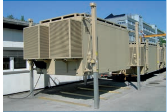
Hebesystem Typ 260 mit automatischer Lageregelung.
