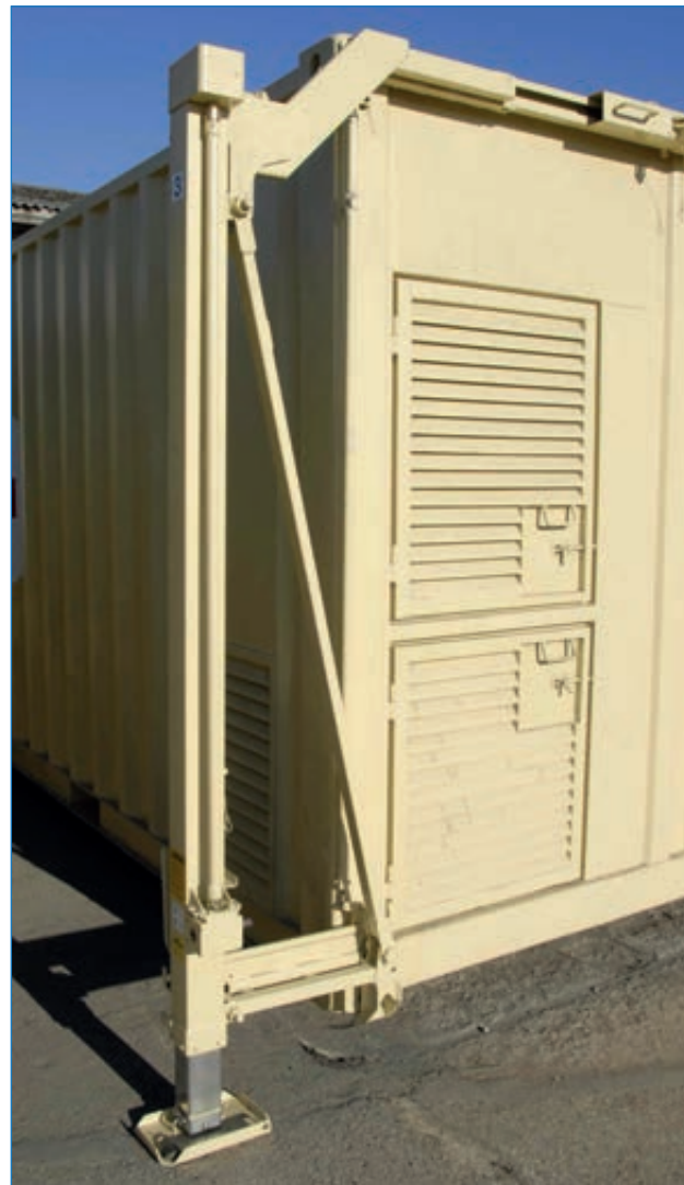
Manuelles Hebesystem Typ 257 mit Schubausleger.
