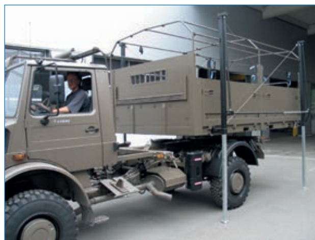
Absetzvorrichtung Typ 297/B zum Wechseln der Module auf dem Fahrzeug.
