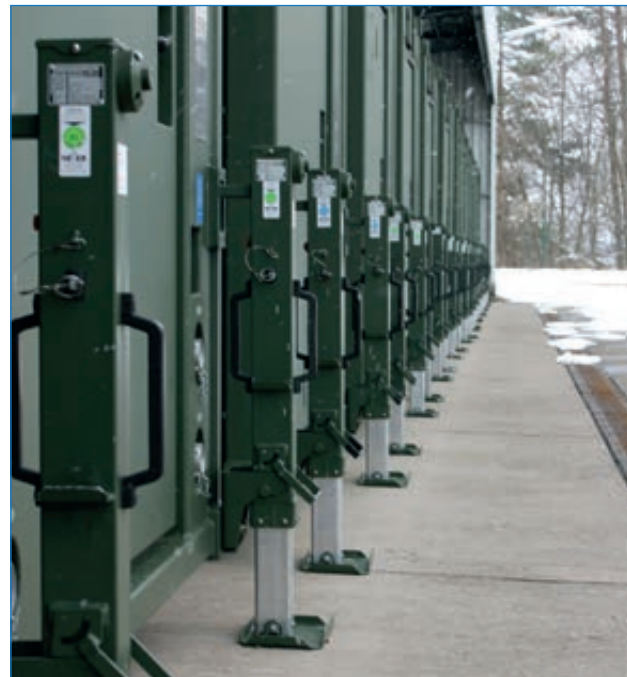
Nivellierstützen Typ 248 an Containern für Feldlager.
