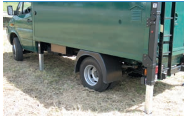
Nivellierstützen Typ 287/B mit automatischer Nivellierung.
