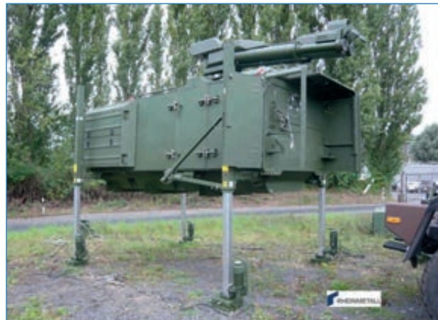
Funktionsmodul mit Absetzsystem auf Basis Typ 296/A.
