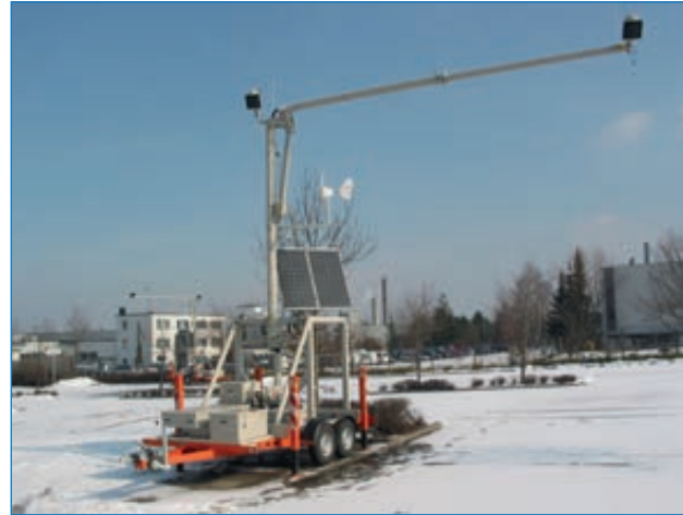
Nivellierstützen Typ 282 für mobile Straßenmaut-Station.
