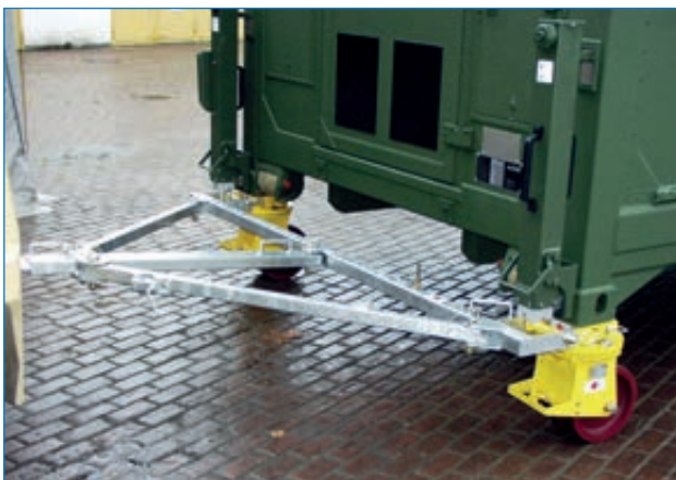
Hebesystem Typ 260 mit Schubausleger für Feuerwehreinsatz- leitung.
