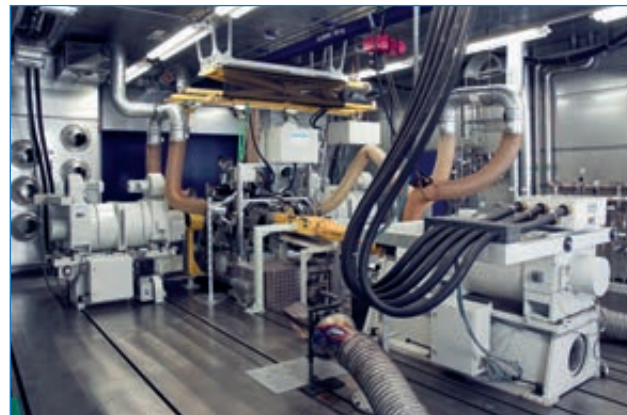
Scherenhubeinrichtung Typ 271 für Motoren- und Getriebepprüfstände.
